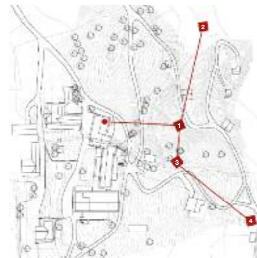
Das Nahwärme-Leitungsnetz versorgt Lufthütten und zentrale Gebäude
